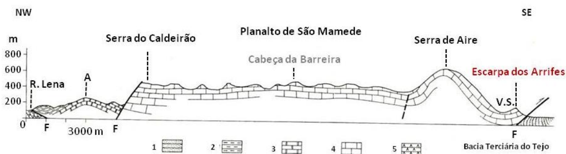
Figura 4 – Corte esquemático da região setentrional do Maciço Calcário Estremenho de FERNANDES MARTINS (1949). Legenda: 1- Margas hetangianas; 2 - Calcários do Dogger; 3 - Calcários do Lusitaniano; 4 - Camadas calco-argilosas do Kimeridgiano; 5 - Formações da Bacia Terciária do Tejo. Abreviaturas: A - Anticlinal de Alqueidão; V.S - Vale da Serra. Escala horizontal: 1/100 000. Altura exagerada quatro vezes.
